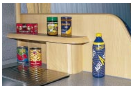
Verkleidet: Die Abdeckung des Pfostens für die obere Gurtbefestigung ist als zusätzliches Ablagebord ausgebildet.
