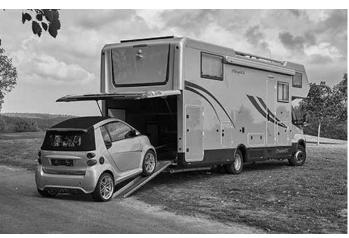
Al instalar los accesorios enumerados anteriormente, la masa del vehículo sin carga aumenta y reduce la posible carga útil. Ilustración en parte de equipo especial.
